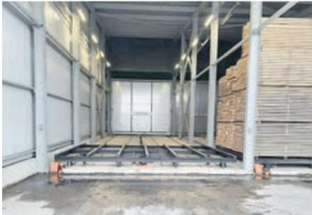
В Вельском ЛПК сотрудники сушильного комплекса совместно со службой РТС изготовили и установили специальные захваты для сушильных тоннелей Хейнола. Устройства служат для стягивания двух тележек, перемещающих пиломатериалы внутри объекта. С их внедрением увеличилась скорость выгрузки сухих пиломатериалов, что, в свою очередь, положительно сказалось на сроках сушки в целом.
