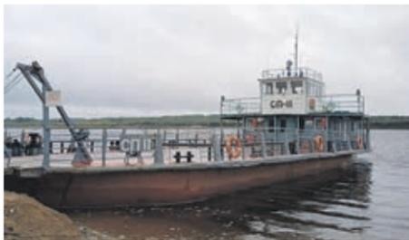
В Виноградовском ЛПХ выполнена комплексная модернизация парама СП-11, позволяющая эксплуатировать судно для перевозки опасных грузов. В ходе работ установлено оборудование, предотвращающее утечку топлива, выход из строя двигателя и возгорание узлов и агрегатов. Благодаря этому паром можно безопасно использовать для транспортировки бензовозов, которые поставляют ГСМ в леспромхоз.
